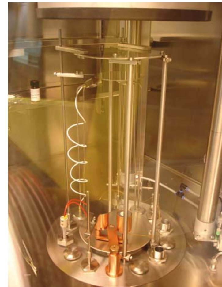
EVAPORADOR DE MOLÉCULAS UTILIZADO EN LA PREPARACIÓN DE PELÍCULAS MOLECULARES DE GROSOR NANOMÉTRICO. FOTO: ICMOL
