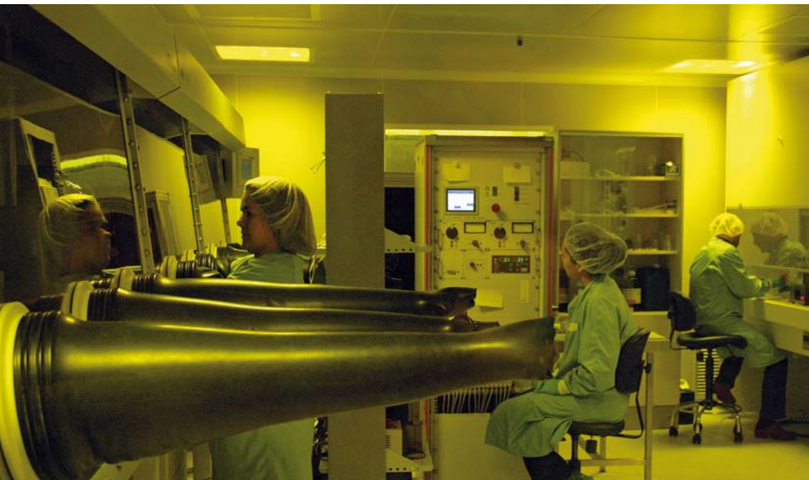
LABORATORIO DE ELECTRÓNICA MOLECULAR: SALA LIMPIA DONDE SE FABRICAN LOS DISPOSITIVOS ELECTRÓNICOS MOLECULARES (DIODOS ORGÁNICOS EMISORES DE LUZ, CÉLULAS FOTOVOLTAICAS MOLECULARES, MULTICAPAS MAGNÉTICAS MOLECULARES, ETC.). FOTO: ICMOL
